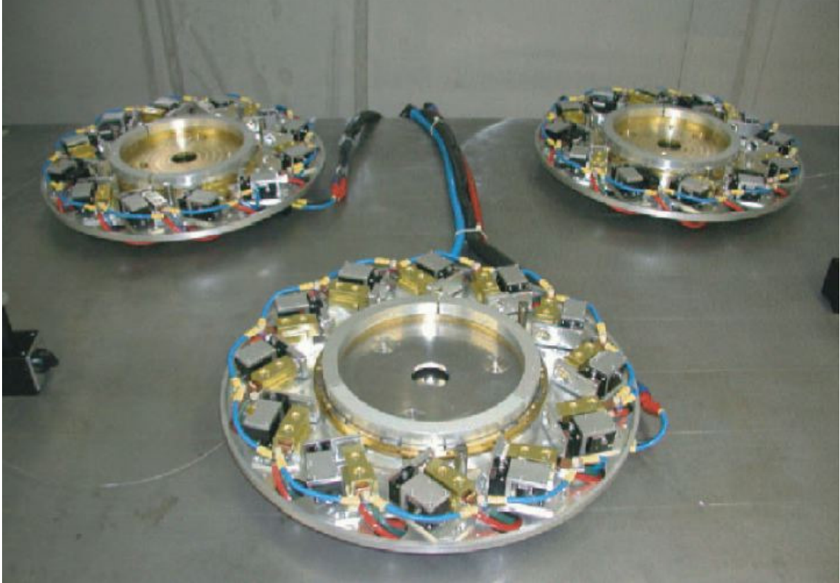
Fig:9.9 Exemplu de tip de laser folosit la sinterizarea selectiva (Ytterbium-fiber laser 200W).
