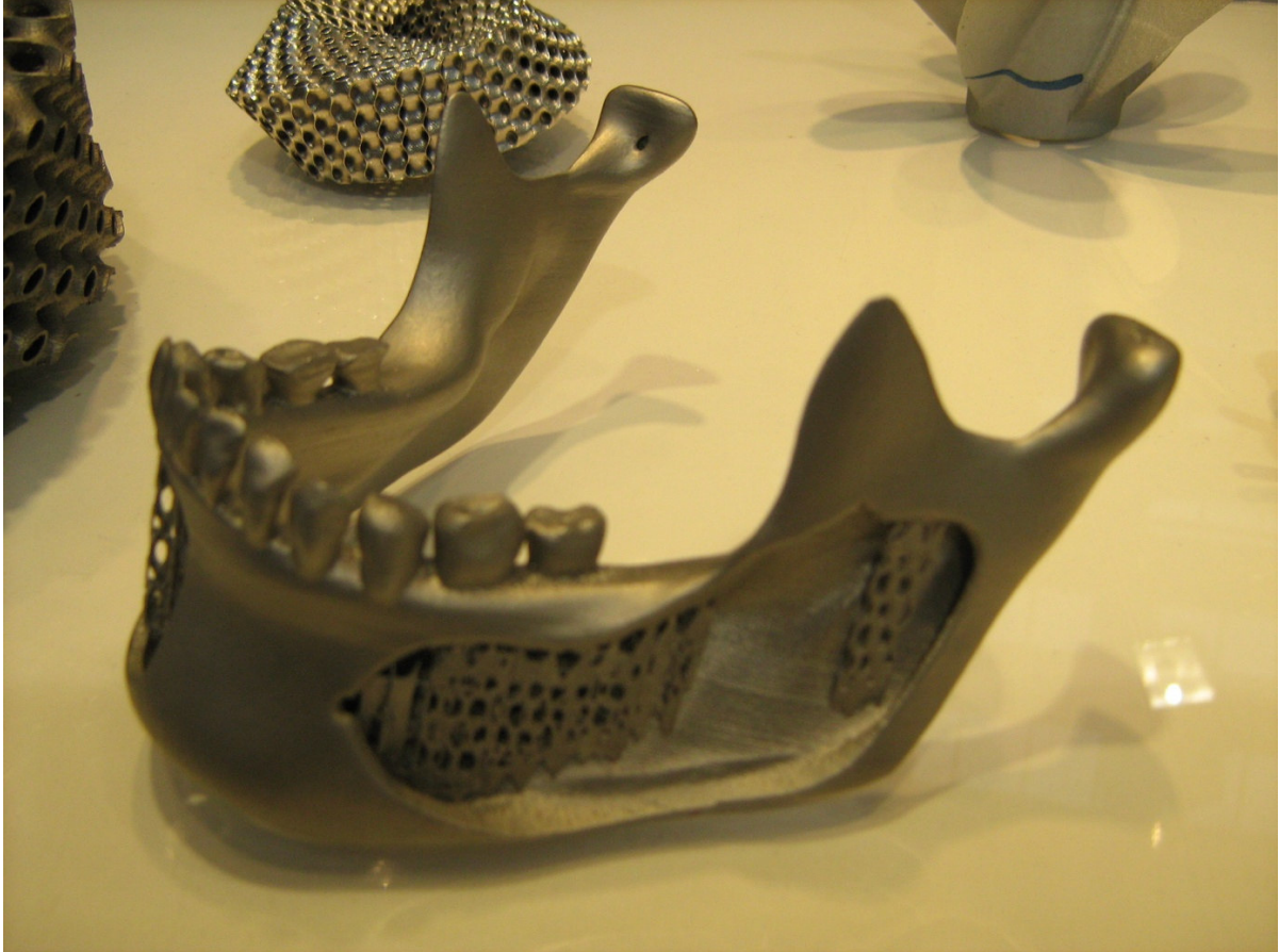
Fig:9.7 piesa ce demonstreaza varietatea structurala ce se poate obtine prin sinterizare cu laser
