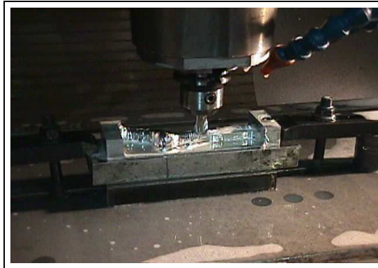
Figura 55. Realizarea implantului pe masina de frezat CNC
