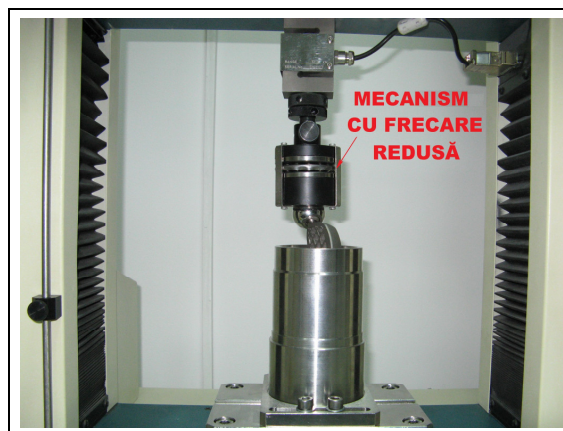
Figura 3.52: Poziționarea protezei pe mașina H10KT
