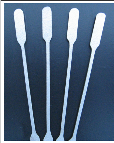
Figura 3.41: Epruvetele pentru determinarea proprietăților mecanice
