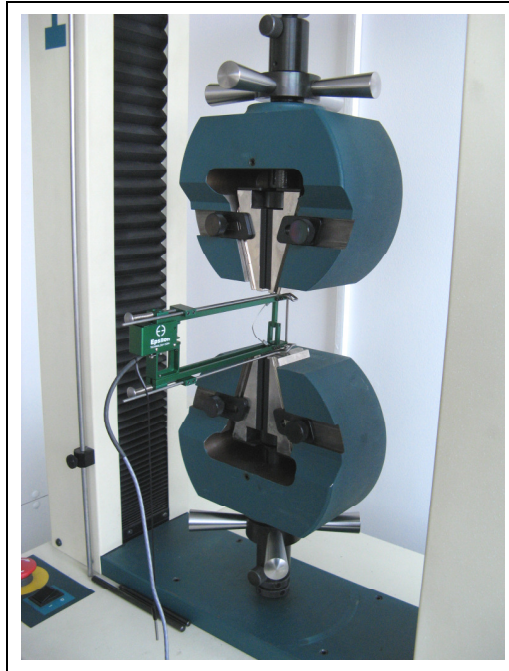
Figura 3.42: Prinderea probelor pe mașina H10KT
